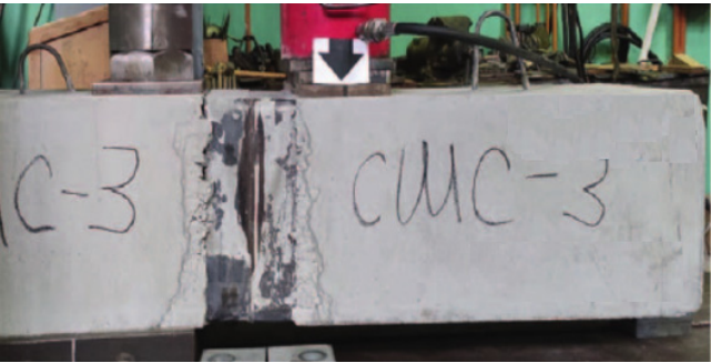
Рисунок 9. – Характер разрушения опытных образцов (тип нагрузки: поперечный сдвиг) сборных железобетонных свай различной длины, соединённых штифтовым узлом
