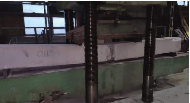
Рисунок 10. – Характер разрушения опытных образцов (тип нагрузки: изгиб) сборных железобетонных свай различной длины, соединённых штифтовым узлом
