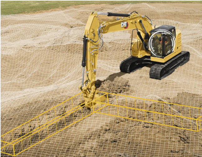
Рис. 2 Cat 330 с виртуальной визуализацией разметки рабочей зоны с применением системы Cat Grade с 3D
