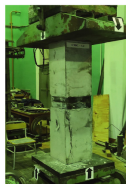
Рисунок 7. – Характер разрушения опытных образцов (тип нагрузки: сжатие) сборных железобетонных свай различной длины, соединённых штифтовым узлом
