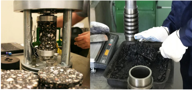
Рис. 2 Лабораторное исследование пробы асфальтобетона
