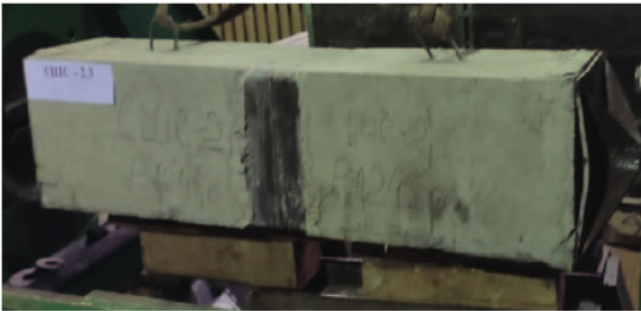
Рисунок 8. – Характер разрушения закладных деталей (тип нагрузки: растяжение) установленных в сборных железобетонных сваях различной длины, соединённых штифтовым узлом
